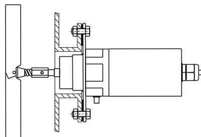
Стандартная муфтовая лопасть 40x98 мм позволяет производить установку датчика в штуцерный ввод длиной до 40 мм без ее демонтажа. При наличии штуцерного ввода большей длины, а также в условиях ограниченного пространства, необходимо применять датчик со складной лопастью 28x200 мм.
