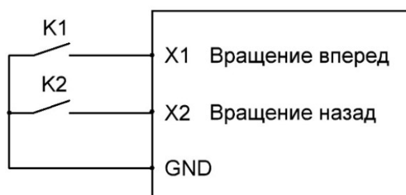
Рис. 5-11 Принципиальная схема двухпроводного режима работы
