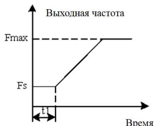
Рис.6-3 Пусковая частота и время выдержки пусковой частоты
