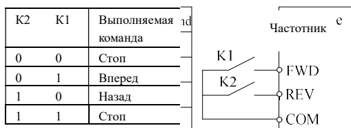
Рис.6-13 Двухпроводной режим управления 1
